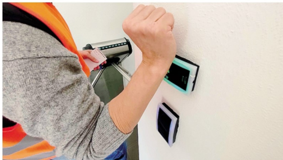
I rilevatori automatici di temperatura che consentono (o impediscono) l'accesso agli spogliatoi. MENEGAZZO
