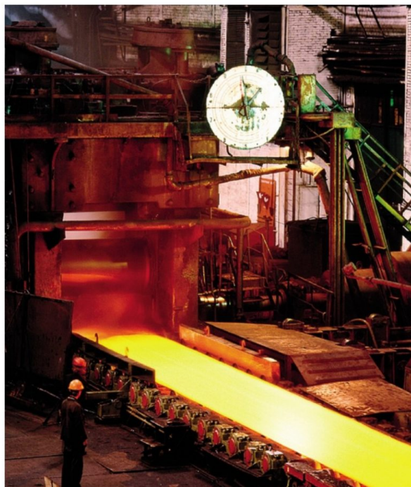
La filiera siderurgica ha produzioni con un alto consumo di energia. Nella foto, il laminatoio del Calceotto
